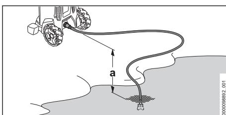
Aby bylo možné nasávat vodu, nesmí výškový rozdíl mezi vysokotlakým čističem a vodním
